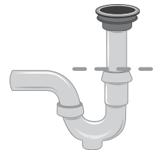
Tubo de desagüe Drain pipe
