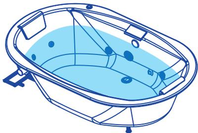
**C** Encender los sistemas del hidromasaje y dejar que funcione durante un periodo de tiempo entre **15 y 20 minutos**, haciendo que el agua con jabón limpie el interior de las tuberías, eliminando así cualquier residuo en las mismas.
