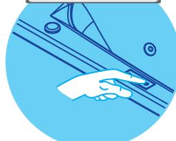
**Encendido y apagado** de los jets de agua
