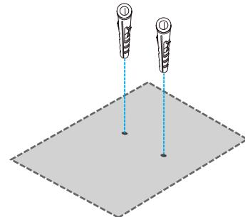
3. Instale la válvula pedal en la ubicación elegida ajústela con los tornillos.
