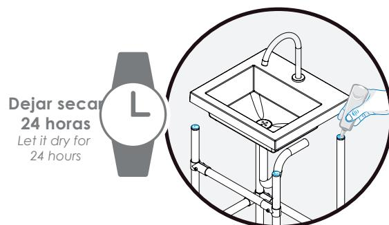
**D** Una vez que el adhesivo haya secado, conecte las conexiones de desagüe y suministro de agua. **Refuerce las conexiones con cinta de teflón, para evitar fugas.**
