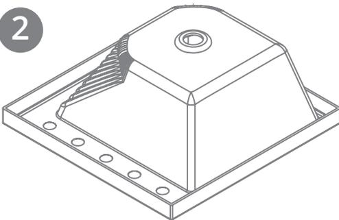
Haga una pequeña perforación solo con la broca guía, buscando el punto céntrico del orificio en el que desee instalar la grifería.
