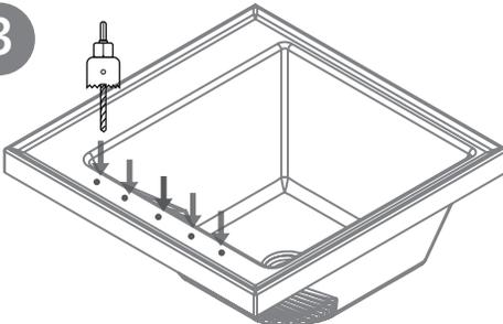
Perfore los orificios insinuados para instalar la grifería usando la copa sierra de 1 1/4". Esto se debe hacer con el lavarropas hacia arriba. Este proceso se repite para las perforaciones que la grifería requiera.
