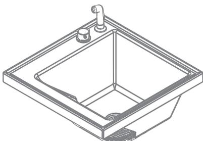
Se procede a instalar la grifería después de haber perforado perfectamente el orificio. (Lavarropas con grifería instalada).
