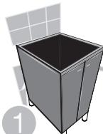
**1** Fije el mueble de madera a la pared utilizando chazos y tornillos.
